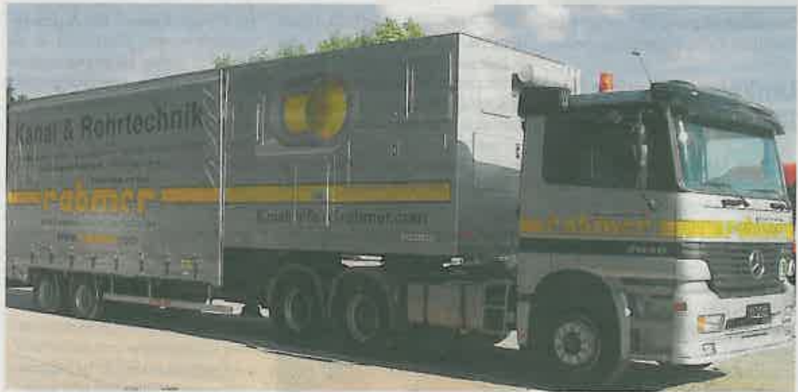
Eine Rohrsanierungsanlage der Rabmer Bau Gruppe saniert im Durchschnitt 100 bis 250 Meter Leitungen pro Tag. Installationslängen von über 500 Metern sind ohne Grabung möglich. Foto: Rabmer Gruppe
